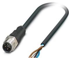
Cavo sensore/attuatore, 4-poli, miscela speciale a base PVC, nero RAL 9005, Maschio diritto M12, codifica: A, su estremità conduttore libera, lunghezza cavo: 10 m, per l'industria alimentare, con zigrinatura in acciaio inox
