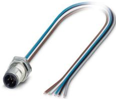
Connettore per apparecchi posteriore, Universale, 5-poli, Connettore, diritto, M12-SPEEDCON, A-codifica, su estremità conduttore libera, Fili singoli, lunghezza cavo: 0,5 m, 0,34 mm<sup>2</sup>, Filo in TPE, saldato, questo articolo dovrebbe essere privo di piombo dal secondo trimestre 2026 secondo la RoHS II senza l'eccezione 6c (Pb < 0,1 %), un'alternativa priva di piombo è disponibile in anticipo su richiesta
