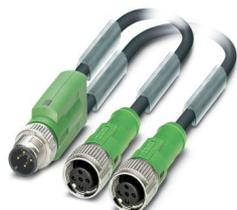
Cavo sensore/attuatore, 5-poli, PUR senza alogenati, grigio-nero RAL 7021, Maschio diritto M12 SPEEDCON, codifica: A, su Connettore femmina diritto M12 SPEEDCON, codifica: A, PIN 2+4 ponticellati, lunghezza cavo: 0,3 m
