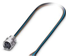
Connettore per apparecchi anteriore, 3-poli, Femmina, diritto, M8, codifica: A, Montaggio anteriore, M8 x 0,5, Fili singoli, lunghezza cavo: 1 m, 0,25 mm<sup>2</sup>, filo in PVC
