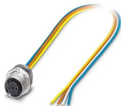
Connettore per apparecchi anteriore, PROFINET CAT5 (IEC 11801:2002), 4-poli, Femmina, diritto, M12-SPEEDCON, codifica: D, su estremità conduttore libera, Montaggio anteriore, M16 x 1,5, Fili singoli, lunghezza cavo: 0,5 m, 0,34 mm<sup>2</sup>, Filo in TPE, saldato, L'articolo è senza piombo secondo la direttiva RoHS II senza eccezione 6c (Pb < 0,1 %)
