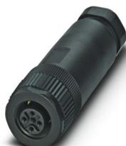
Connettore dati, 5-poli, Femmina diritto M12, codifica: B, Connessione a vite, materiale zigrinato: Plastica, connessione a vite per cavo Pg9, diametro esterno conduttore 6 mm ... 8 mm
