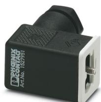
Connettore per valvole, 3-poli, Connettore per valvole C (8 mm), Connessione a vite, connessione a vite per cavo Pg9, diametro esterno conduttore 6 mm ... 8 mm
