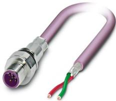
Connettore per apparecchi anteriore, 2-poli senza alogenati, lilla rossastro RAL 4001, schermata, Connettore, diritto, M12, B-codifica, su estremità conduttore libera, Collegamento del cavo, lunghezza cavo: 10 m, PROFIBUS
