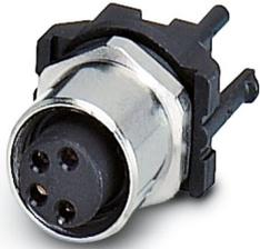
Connettore per apparecchi posteriore, 4-poli, Femmina, diritto, M8, A-codifica, Saldatura a onde
