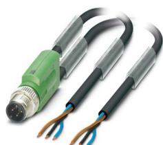
Cavo sensore/attuatore, 3-poli, PUR senza alogenati, grigio-nero RAL 7021, Maschio diritto M12 SPEEDCON, codifica: A, su estremità conduttore libera e estremità conduttore libera, lunghezza cavo: 3 m
