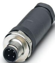
Connettore, 4-poli, Maschio diritto M12, codifica: A, Connessione a vite, materiale zigrinato: Pressogetto di zinco, nichelato, connessione a vite per cavo Pg9, diametro esterno conduttore 6 mm ... 8 mm
