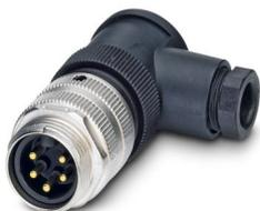
Connettore, Universale, 5-poli, Maschio angolato 7/8"-16UNF, codifica: A, Connessione a vite, materiale zigrinato: Pressogetto di zinco, nichelato, connessione a vite per cavo Pg9, diametro esterno conduttore 6 mm ... 8 mm, Contatto 3 anticipato
