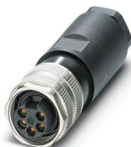
Connettore, Universale, 5-poli, Femmina diritto 7/8"-16UNF, codifica: A, Connessione a vite, materiale zigrinato: Pressogetto di zinco, nichelato, connessione a vite per cavo Pg13,5, diametro esterno conduttore 10 mm ... 12 mm
