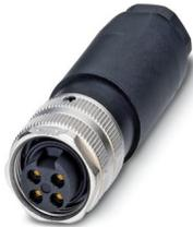
Connettore, Universale, 4-poli, Femmina diritto 7/8"-16UNF, codifica: A, Connessione a vite, materiale zigrinato: Pressogetto di zinco, nichelato, connessione a vite per cavo Pg13,5, diametro esterno conduttore 10 mm ... 12 mm
