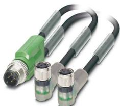
Cavo sensore/attuatore, 3-poli, PUR senza alogenati, grigio-nero RAL 7021, Maschio dritto M12, codifica: A, su Connettore femmina angolato M8, codifica: A, con 2 LED e Connettore femmina angolato M8, codifica: A, con 2 LED, lunghezza cavo: 2 m
