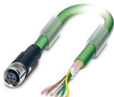
Cavo di sistema bus, INTERBUS (16 MBit/s), 5-poli, PUR senza alogenati, verde pallido RAL 6017, schermata, estremità conduttore libera, su Connettore femmina diritto M12 SPEEDCON, codifica: B, lunghezza cavo: 2 m
