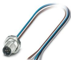
Connettore per apparecchi posteriore, 5-poli, Connettore, diritto, M12, codifica: A, su estremità conduttore libera, Montaggio posteriore, Pg9, Fili singoli, lunghezza cavo: 0,5 m, 0,34 mm<sup>2</sup>, Filo in TPE, saldato
