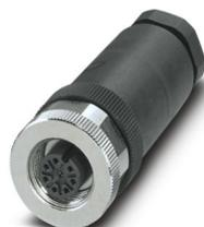
Connettore, Universale, 8-poli, Femmina diritto M12, codifica: A, Connessione a vite, materiale zigrinato: Ottone, nichelato, connessione a vite per cavo Pg9, diametro esterno conduttore 6 mm ... 8 mm
