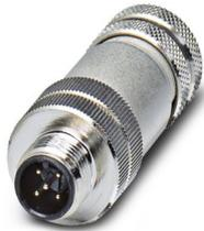
Connettore dati, CAN BUS/DeviceNet, 5-poli, schermata, Maschio diritto M12, codifica: A, Connessione a vite, materiale zigrinato: Pressogetto di zinco, nichelato, connessione a vite per cavo Pg9, diametro esterno conduttore 6,5 mm ... 8,5 mm
