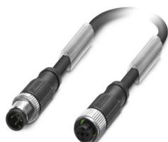
Cavo sensore/attuatore, 4-poli, PUR senza alogenati, grigio-nero RAL 7021, schermata (Advanced Shielding Technology), Maschio diritto M12, codifica: A, su Connettore femmina diritto M12, codifica: A, lunghezza cavo: 10 m
