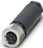
Connettore, Universale, 4-poli, Femmina diritto M8, codifica: A, Connessione a vite, materiale zigrinato: Ottone, nichelato, diametro esterno conduttore 3,5 mm ... 5 mm
