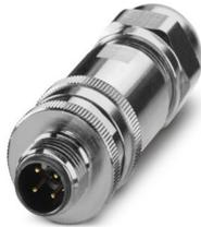
Connettore, Universale, 4-poli, schermata, Maschio diritto M12, codifica: A, Connessione a vite, materiale zigrinato: Ottone, nichelato, connessione a vite per cavo Pg9, diametro esterno conduttore 6 mm ... 8 mm
