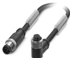
Cavo sensore/attuatore, 5-poli, PUR senza alogenati, grigio-nero RAL 7021, schermata (Advanced Shielding Technology), Maschio diritto M12, codifica: A, su Connettore femmina angolato M12, codifica: A, lunghezza cavo: 0,6 m
