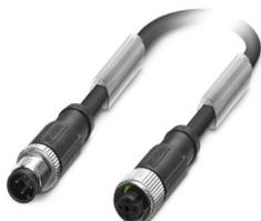
Cavo sensore/attuatore, 4-poli, PUR senza alogenati, grigio-nero RAL 7021, schermata (Advanced Shielding Technology), Maschio diritto M12, codifica: A, su Connettore femmina diritto M12, codifica: A, lunghezza cavo: 0,6 m
