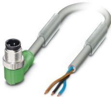
Cavo sensore/attuatore, 3-poli, PUR senza alogenati, resistente agli spruzzi di saldatura, altamente flessibile, grigio RAL 7001, Maschio angolato M12, codifica: A, su estremità conduttore libera, lunghezza cavo: 10 m, per robot e catene portacavi
