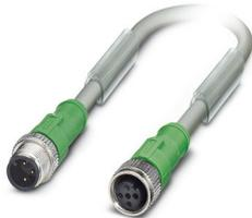
Cavo sensore/attuatore, 3-poli, PUR senza alogenati, resistente agli spruzzi di saldatura, altamente flessibile, grigio RAL 7001, Maschio diritto M12, codifica: A, su Connettore femmina diritto M12, codifica: A, lunghezza cavo: 0,6 m, per robot e catene portacavi
