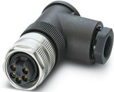
Connettore, Universale, 5-poli, Femmina angolato 7/8"-16UNF, codifica: A, Connessione a vite, materiale zigrinato: Pressogetto di zinco, nichelato, connessione a vite per cavo Pg11, diametro esterno conduttore 8 mm ... 10 mm
