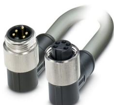
Cavo di alimentazione, 5-poli, PVC, grigio RAL 7001, Maschio angolato 7/8"-16UNF, codifica: A, su Connettore femmina angolato 7/8"-16UNF, lunghezza cavo: 0,3 m, Sezione conduttore 2,5 mm<sup>2</sup>, per alimentazione
