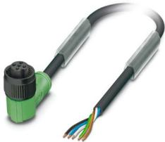
Cavo sensore/attuatore, 5-poli, PUR senza alogenati, grigio-nero RAL 7021, estremità conduttore libera, su Connettore femmina angolato M12, codifica: A, lunghezza cavo: 10 m, con ghiera in plastica
