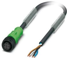
Cavo sensore/attuatore, 4-poli, PUR senza alogenati, grigio-nero RAL 7021, estremità conduttore libera, su Connettore femmina diritto M12, codifica: A, lunghezza cavo: 3 m, con ghiera in plastica
