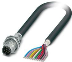
Connettore per apparecchi posteriore, Universale, 12-poli, PVC/PVC, nero RAL 9005, schermata, Connettore, diritto, M12-SPEEDCON, A-codifica, su estremità conduttore libera, Collegamento del cavo, lunghezza cavo: 1 m, 0,14 mm<sup>2</sup>, PVC nero, questo articolo dovrebbe essere privo di piombo dal secondo trimestre 2026 secondo la RoHS II senza l'eccezione 6c (Pb < 0,1 %), un'alternativa priva di piombo è disponibile in anticipo su richiesta
