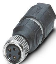
Connettore, Universale, 4-poli, Femmina diritto M8, codifica: A, Connessione a perforazione di isolante, materiale zigrinato: Pressogetto di zinco, nichelato, diametro esterno conduttore 2,5 mm ... 5 mm
