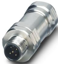
Connettore, 5-poli, schermata, Maschio diritto M12, codifica: A, Connessione a vite, materiale zigrinato: Acciaio legato 1.4404, connessione a vite per cavo M16, diametro esterno conduttore 3 mm ... 5,5 mm
