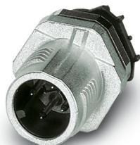
Connettore maschio da incasso sensore-attuatore, maschio, 4 poli, M12 SPEEDCON, codifica A, montaggio posteriore/a vite con filettatura M12, connessione a saldare diritta THR
