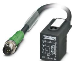
Cavo sensore/attuatore, 3-poli, PUR senza alogenati, grigio-nero RAL 7021, Maschio diritto M12, codifica: A, con 1 LED, su Connettore per valvole BI (11 mm), con 1 LED, Circuito: Diodo Z, lunghezza cavo: 5 m
