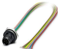
Connettore per apparecchi anteriore, Universale, 8-poli, Connettore, diritto, M12-Standard, A-codifica, su estremità conduttore libera, Fili singoli, lunghezza cavo: 0,5 m, 0,25 mm<sup>2</sup>, Filo in TPE
