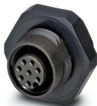
Connettore femmina da incasso sensore-attuatore, 8 poli, M12, codifica A, montaggio posteriore/a vite con filettatura Pg9, con connessione a saldare, variante in plastica
