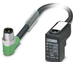
Cavo sensore/attuatore, 3-poli, PUR senza alogenati, grigio-nero RAL 7021, Maschio angolato M12 SPEEDCON, codifica: A, con 1 LED , su Connettore per valvole CI (9,4 mm), con 1 LED , Circuito: Diodo Z, lunghezza cavo: 1,5 m
