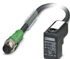
Cavo sensore/attuatore, 3-poli, PUR senza alogenati, grigio-nero RAL 7021, Maschio diritto M12 SPEEDCON, codifica: A, su Connettore per valvole C (8 mm), con 1 LED , Circuito: Diodo Z, lunghezza cavo: 3 m
