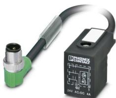
Cavo sensore/attuatore, 3-poli, PUR senza alogenati, grigio-nero RAL 7021, Maschio angolato M12 SPEEDCON, codifica: A, con 1 LED , su Connettore per valvole B (10 mm), con 1 LED , Circuito: Diodo Z, lunghezza cavo: 0,3 m
