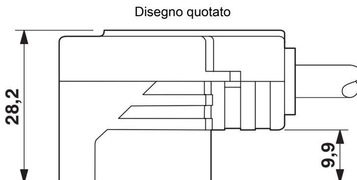
Connettore per valvole, formato AD, vista laterale
