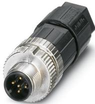
Connettore, 5-poli, Maschio diritto M12 SPEEDCON, codifica: A, Connessione a molla, materiale zigrinato: Pressogetto di zinco, nichelato, diametro esterno conduttore 4 mm ... 8 mm
