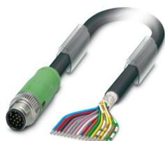
Cavo sensore/attuatore, 17-poli, PUR/PVC, nero RAL 9005, schermata, Maschio diritto M12 SPEEDCON, codifica: A, su estremità conduttore libera, lunghezza cavo: 10 m
