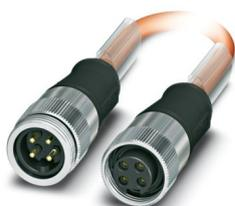
Cavo di sistema bus, FOUNDATION Fieldbus (31,25 kBit/s), 3-poli, PVC, arancio RAL 2003, schermata, Maschio diritto 7/8"-16UNF, codifica: A, su Connettore femmina diritto 7/8"-16UNF, codifica: A, lunghezza cavo: 50 m
