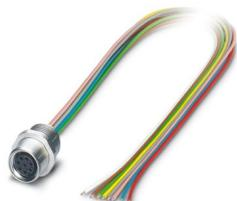
Connettore per apparecchi anteriore, 8-poli, Femmina, diritto, M8, A-codifica, Fili singoli, lunghezza cavo: 0,5 m, 0,14 mm<sup>2</sup>, filo in PVC
