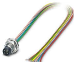
Connettore per apparecchi posteriore, 8-poli, Connettore, diritto, M8, A-codifica, su estremità conduttore libera, Fili singoli, lunghezza cavo: 0,5 m, 0,14 mm<sup>2</sup>, filo in PVC
