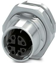
Connettore per apparecchi posteriore, Ethernet CAT6<sub>A</sub> (10 Gbit/s), 8-poli, Femmina, diritto, M12-SPEEDCON, X-codifica, Saldatura a onde, questo articolo dovrebbe essere privo di piombo dal primo trimestre 2026 secondo la RoHS II senza l'eccezione 6c (Pb < 0,1 %), un'alternativa priva di piombo è disponibile in anticipo su richiesta
