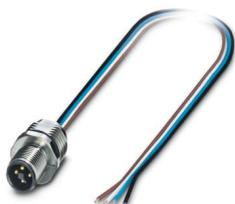
Connettore per apparecchi anteriore, Potenza, 4-poli, Connettore, diritto, M12-Standard, T-codifica, su estremità conduttore libera, Fili singoli, lunghezza cavo: 0,5 m, 1,31 mm<sup>2</sup>, Filo per l'elettronica UL/cUL, saldato, questo articolo dovrebbe essere privo di piombo dal primo trimestre 2026 secondo la RoHS II senza l'eccezione 6c (Pb < 0,1 %), un'alternativa priva di piombo è disponibile in anticipo su richiesta
