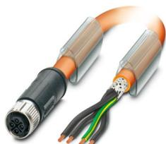
Cavo di alimentazione, 4-poli, PUR senza alogenati, arancio RAL 2003, schermata (Advanced Shielding Technology), estremità conduttore libera, su Connettore femmina diritto M12, codifica: S, lunghezza cavo: 5 m, per corrente alternata fino a 12 A/690 V
