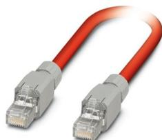
Cavo confezionato Sercos III, schermato, stella quadrupla, AWG 22 flessibile (7 fili), RAL 3020 (rosso traffico), connettore RJ45/IP20, su connettore RJ45/IP20, lunghezza: 2 m
